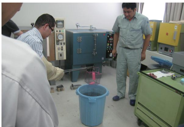
850℃に加熱された試験片を水冷します
